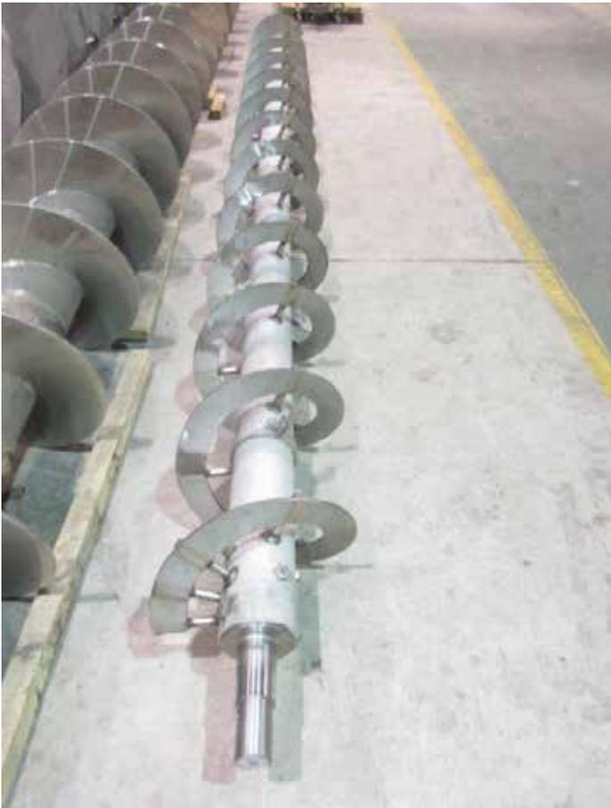
Rosca sinfín con radios de giro a derecha e izquierda para mezclado de productos "avance y retroceso".
